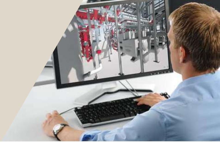
**Modelovanie podpier TZB rozvodov podľa návrhov zo Základného alebo Detailného technického návrhu. Takýmto spôsobom sú namodelované a rozmiestnené podpery s prihladnutím na technickú kvalitu a s rešpektovaním levelu detailu modelu. Akékoľvek iné aplikácie, ktoré sú mimo rozsahu, ktoré vie zabezpečiť Hilti budú označené v modeli, ale nebudú modelované.**
