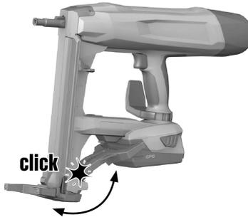
1. Haga presión sobre el pie de apoyo para sacarlo de la posición de encastre.
